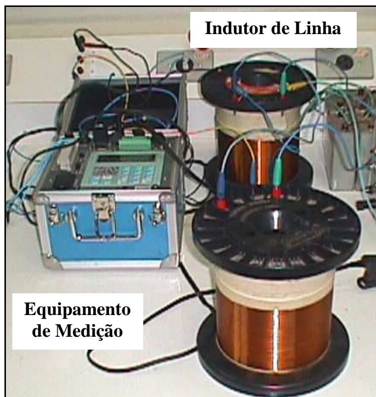
Figura 2.4 – Foto do indutor de linha e do equipamento de medição.
